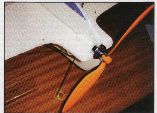
Montage encastré d'un moteur chinois.
